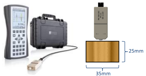
図 1 : MAGNETOSCOP と透磁率測定プローブ (左)、測定中の透磁率測定プローブ (右)
