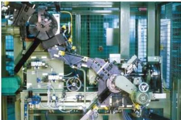
▲ バルブシートリングは、フィードシステム、セパレータユニット、位置制御装置、そして表裏整列装置を通してクラック検査ステーションに入ります。
