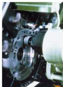
▲ 同時に内側と外側を均一回転の間に検査する探傷装置。
