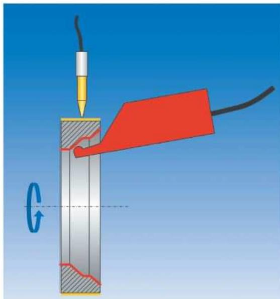
▲ シートリングの内側と外側で同時にクラック検出を行うためにプローブを位置決めします。プローブと材料表面との間の距離は軸フレによって変化し感度差が生まれます。内蔵のクリアランス補正システムによりこれらの感度差は自動的に補われます。そのため、クラック検出感度はすべての部位で均一に保たれます。
