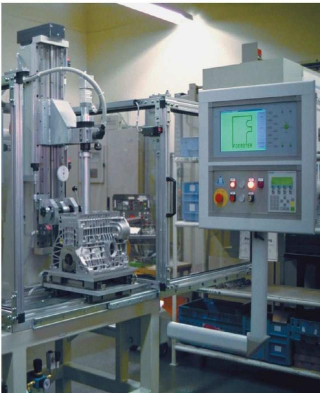
▲ ニッケルコーティングされたシリンダライナーでは、シリンダ表面に施された60~80 $\mu$ m厚のコーティングが母材に対して十分な接着力を有するかどうかチェックしなければなりません。特殊な回転渦流センサで接触表面を螺旋状に走査することにより、クラック、孔および癒着欠陥を確実に検出します。
