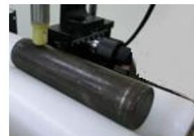
図 2 : ピンの探傷(部品回転)
