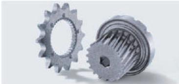
コスト面の理由から、複雑な形状の部品は焼結により製造されることが多くあります。これにはハウジングやファスナーなど軟磁性の部品、駆動装置やモーターなど機械的ストレスを受ける部品が含まれます。Fe(鉄)粉末の原材料品質および焼結前後の粒のサイズと均一な分布は、製造される部品の強度や耐摩耗性などの機械的特性を決定する要因となります。これらのパラメータは保磁力の測定値と相関があります。KOERZIMAT®は、粉体品質の評価から焼結工程の評価まで、製造工程全体の監視に使用できます。
