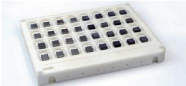
等方加圧による事前加工段階で、すでに空隙のない優れた材料密度を達成することは可能です。KOERZIMAT®測定システムは、製造の初期段階でも粒のサイズと分布、密度の情報を得ることができます。これらの情報は製造工程の管理に必要な不可欠なパラメータです。
