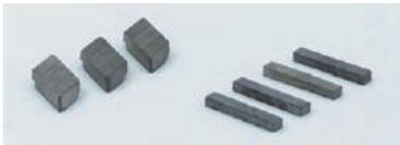
金属射出成形は、射出成形後に焼結して高品質の金属部品を製造する、費用対効果の高い代替手段です。この方法では、原材料粉末と、焼結による結合の両方の品質を評価するために保磁力を使用できます。
