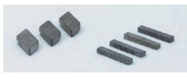
金属射出成形は、射出成形後に焼結して高品質の金属部品を製造する、費用対効果の高い代替手段です。この方法では、原材料粉末と、焼結による結合の両方の品質を評価するために保磁力を使用できます。
